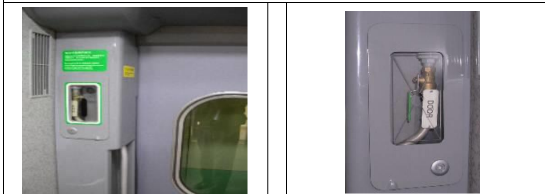
車廂內部側拉門之緊急手動開門把手
