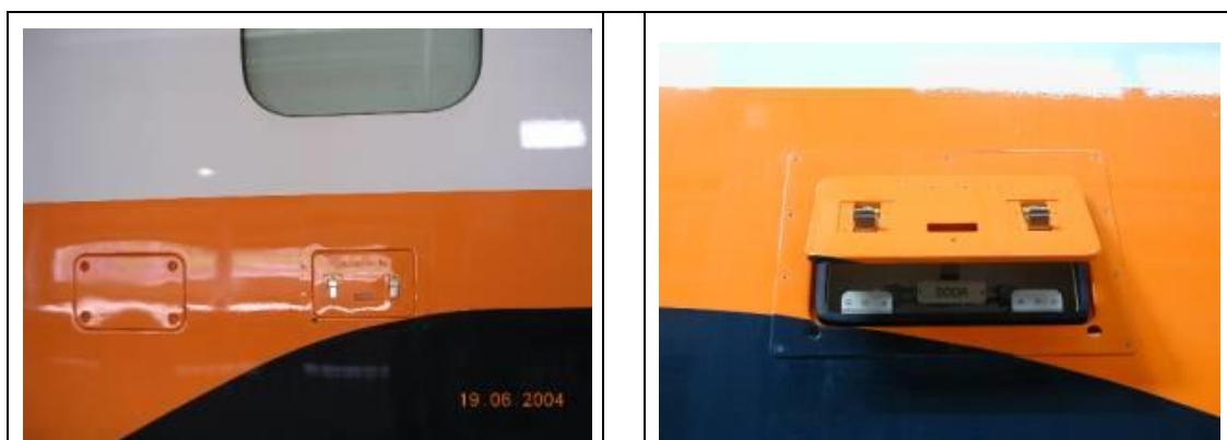
車廂外部側拉門之緊急手動開門把手
